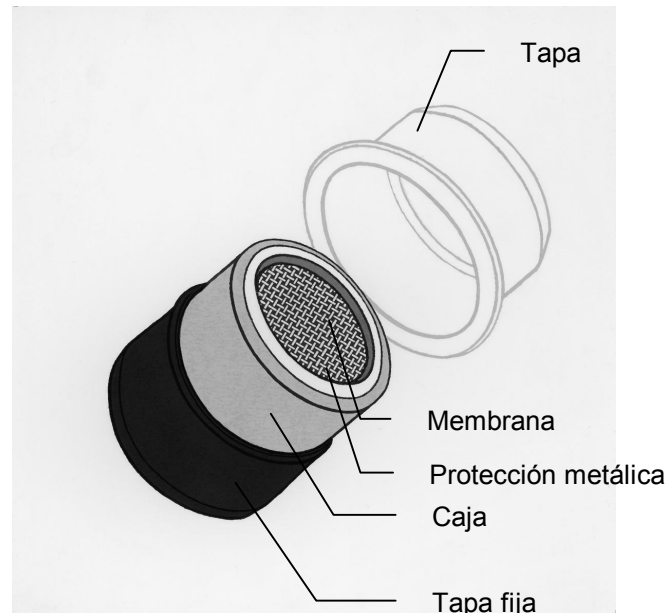
Tubo Pasivo para Sulfuro de Hidrógeno
