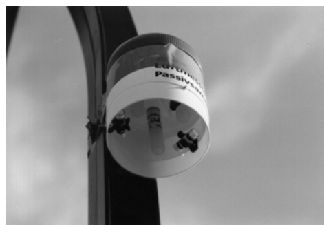
Dispositivo de suspensión para ORSA junto al muestreo pasivo de dióxido de nitrógeno.
